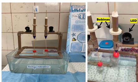
Figura 1 – Protótipo produzido para demonstrar a geração de energia elétrica por uma usina ondomotriz. À esquerda, em vista frontal e à direita, em vista superior.
