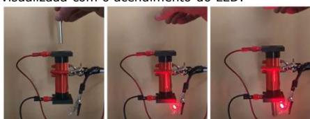
Figura 2 – Experimento de transformação de energia que utiliza o mesmo princípio do protótipo desenvolvido em nosso projeto.
