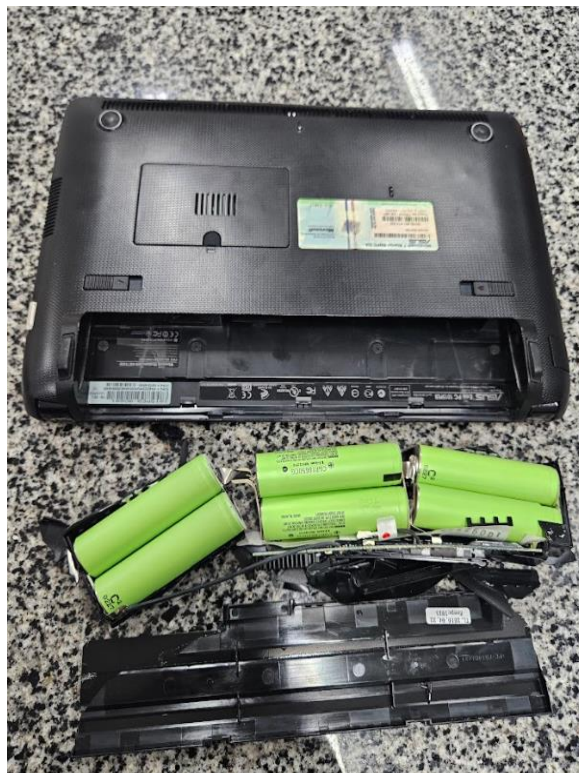
Figura 1 – Notebook descartado e baterias 18650 extraídas
