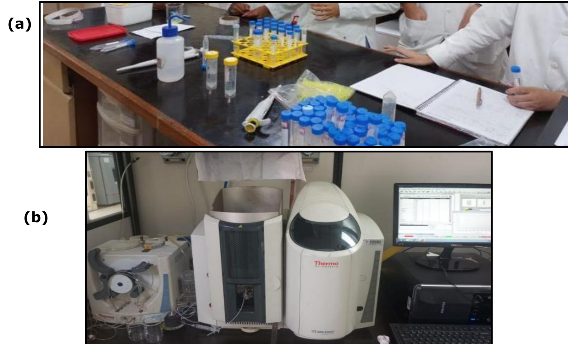
Figura 3. Preparo das soluções (a) e espectrofotômetro de absorção atômica (b). Fonte: imagem registrada pelo autor.
