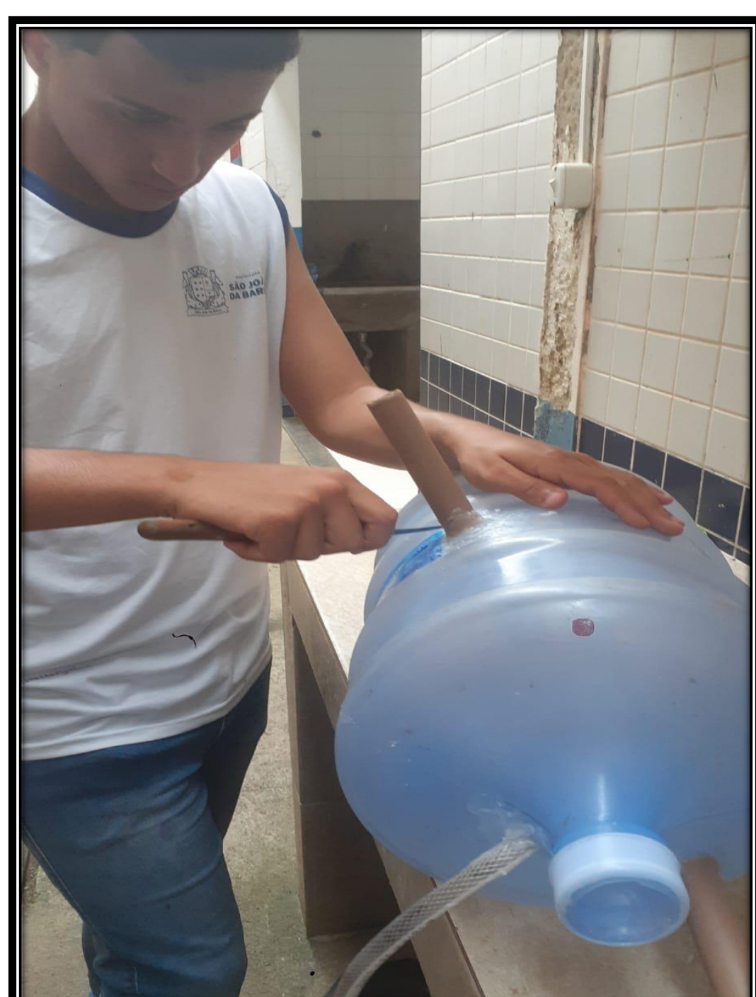
Figura 1 – Biodigestor caseiro sendo confeccionado.
