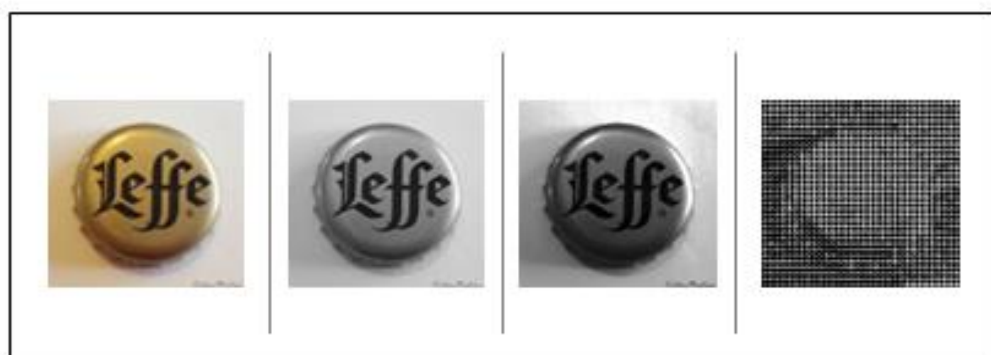
Figura 1 – Exemplo de extração de característica HOG da imagem de um metal.
