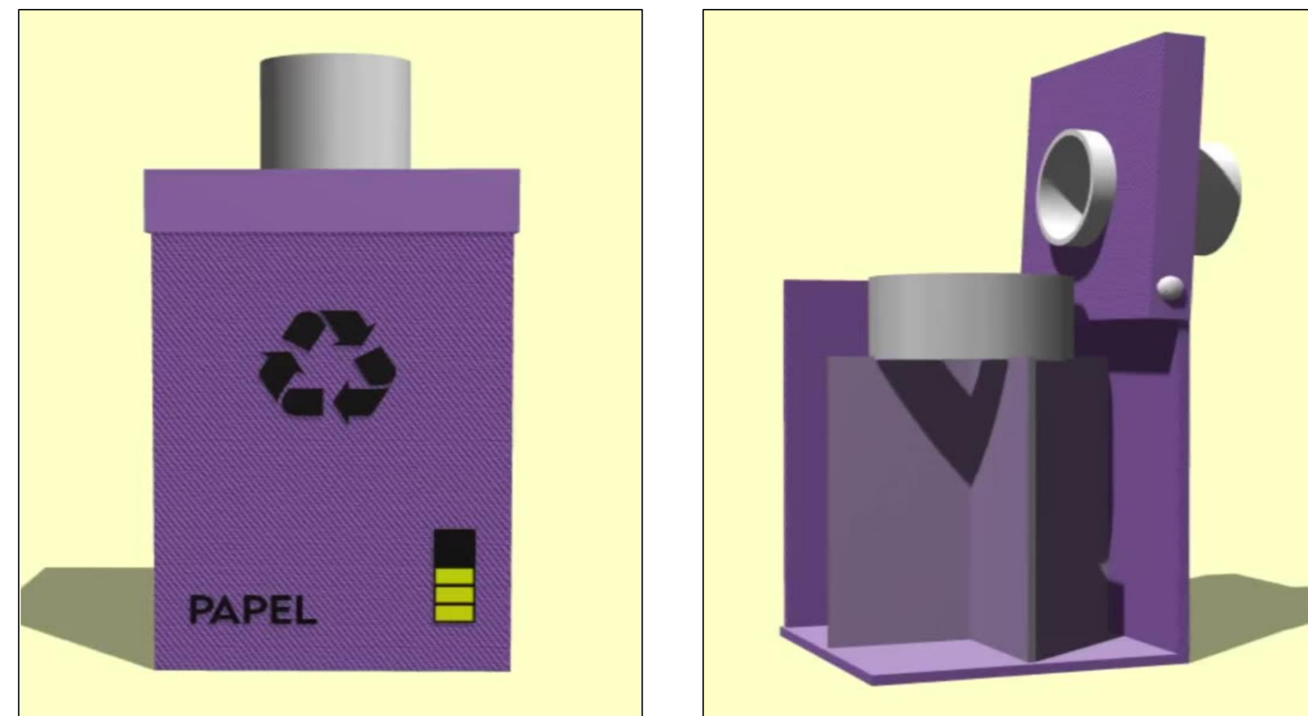
Figura 2 - Modelo 3D do primeiro conceito projetado para a Lixeira Inteligente.
