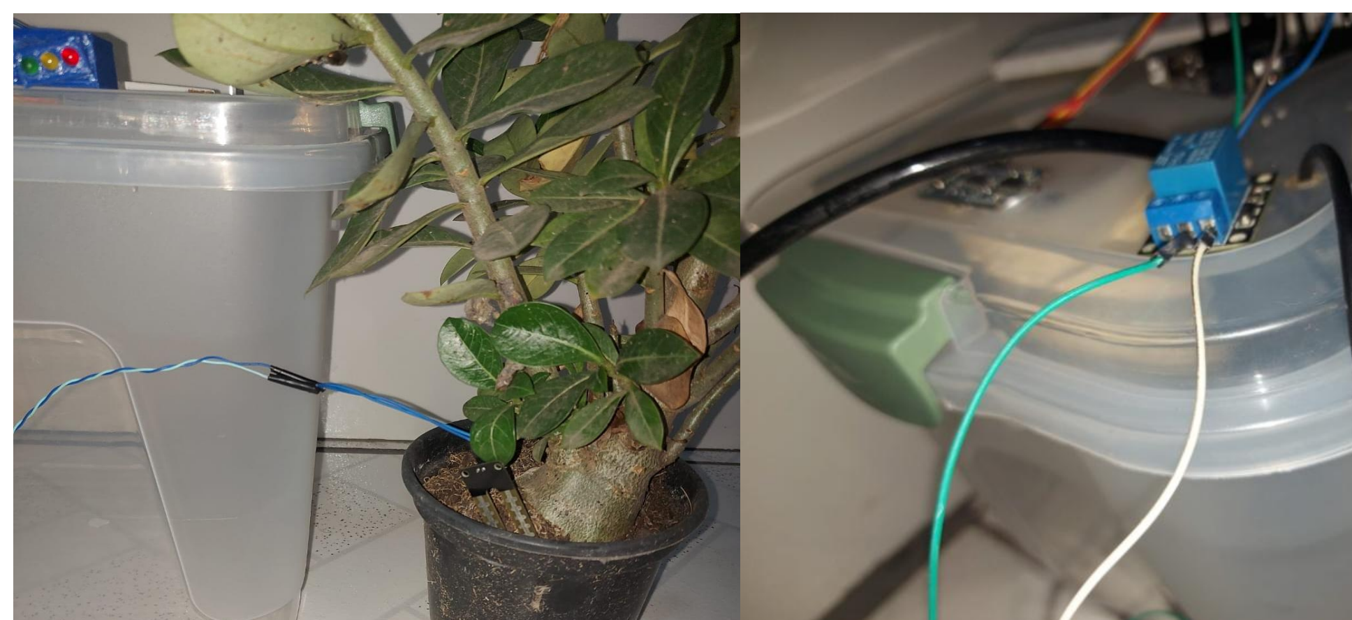
Figura 2–Reservatório com leds e relé acoplados
