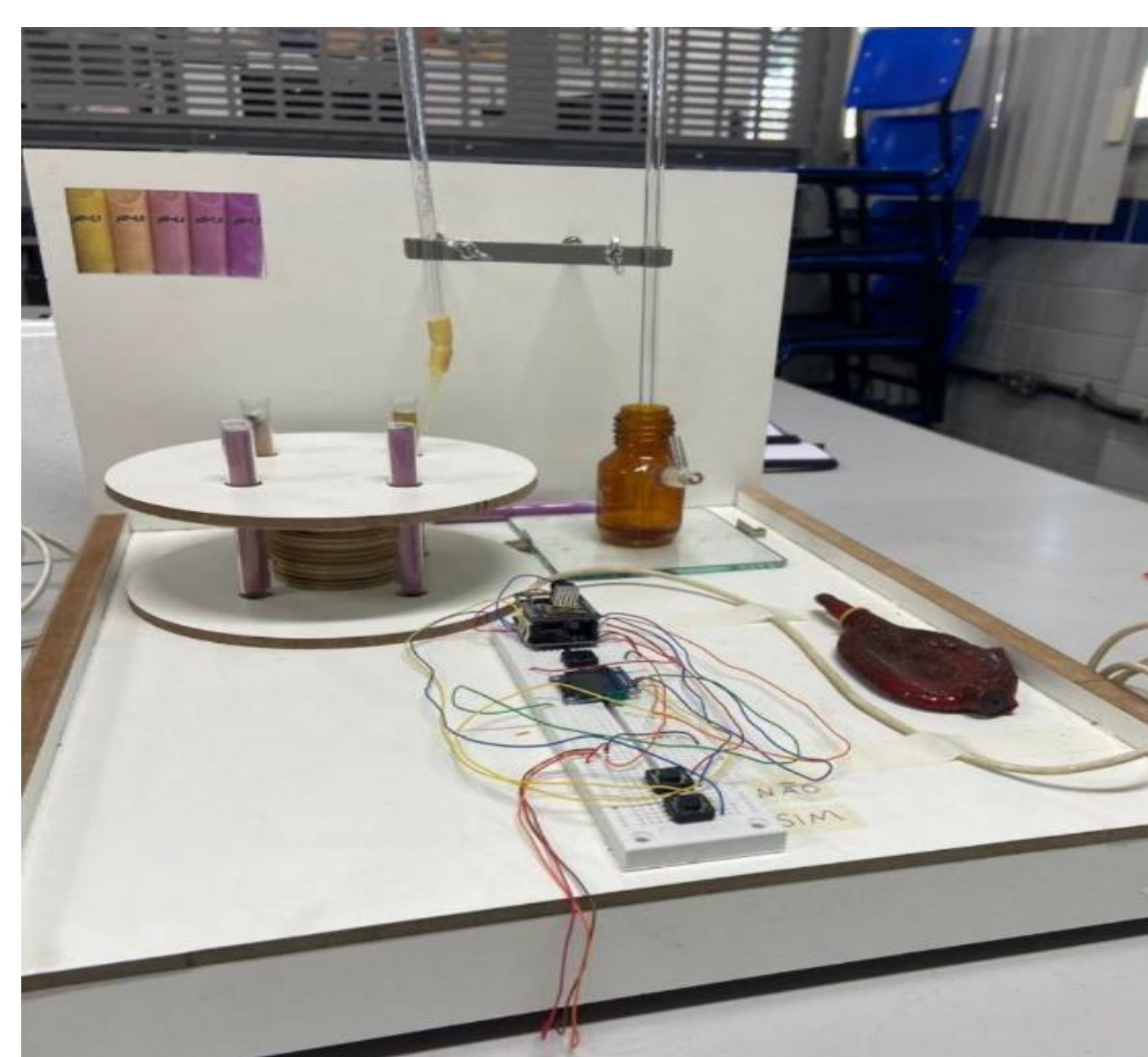
Figura 2 – Primeira versão física do protótipo IoT concebido para ser utilizado no processo de medição de Acidez Dornic. Elaboração própria.
