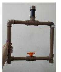
Protótipo de sistema de cloração foi realizado com canos de 25mm, conexões tipo joelho e um registro para regulagem do volume de água.
