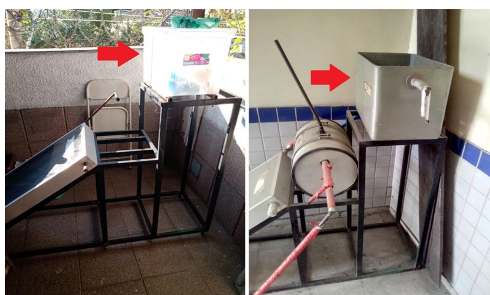
Figuras 3 e 4: Fotos da bancada com o Boiler e com o Reservatório Principal instalado.
